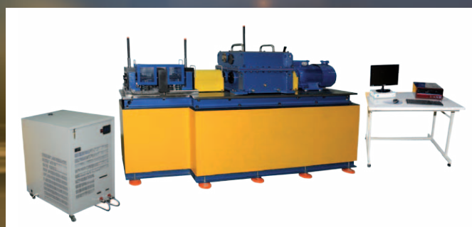
Widok urządzenia T-12UF z systemem pomiarowym oraz wymiennikiem ciepła
