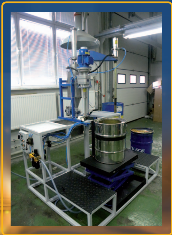
Urządzenie do utylizacji zużytych cieczy obróbkowych
