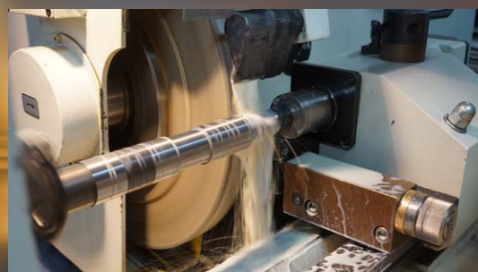
Szlifowanie zregenerowanego czopa łożyska ślizgowego
