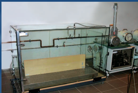
Komora 1000 dm 3 z zespołem przygotowania powietrza
