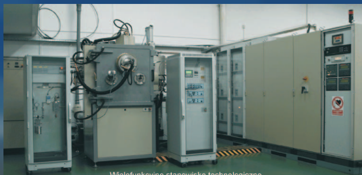
Wielofunkcyjne stanowisko technologiczne do realizacji hybrydowych technologii obróbki powierzchniowej
