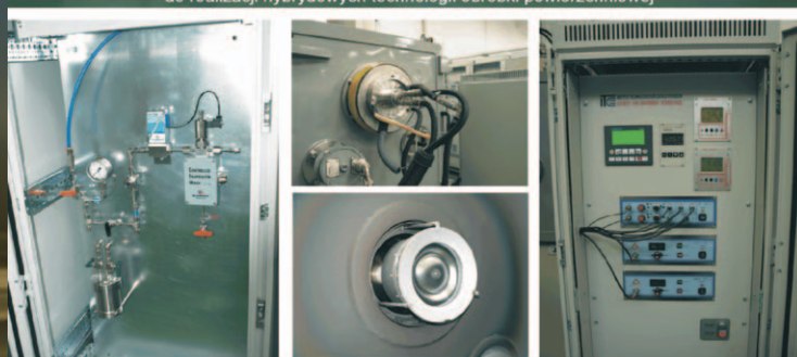
System komponowania atmosfery gazowej z par metali ciekłych
