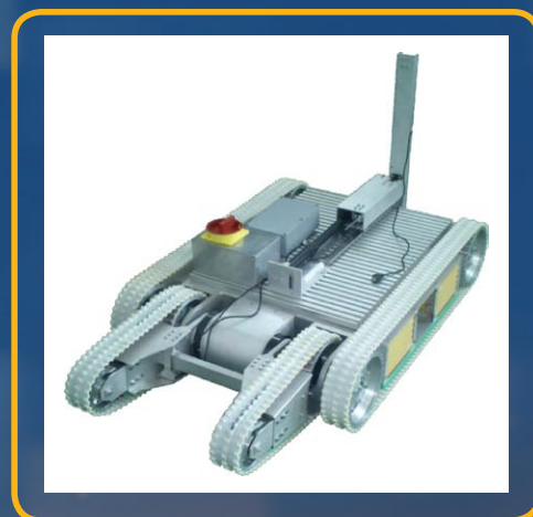
Specjalistyczny robot inspekcyjny Explorer
